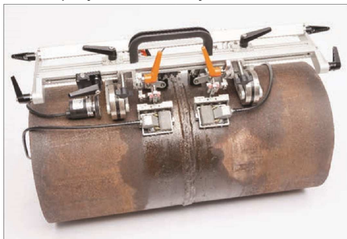
Skaner do manualnego badania spoin na rurach z enkoderem pozycjonującym, uchwytami dla dwóch głowic PA oraz jednej pary TOFD
