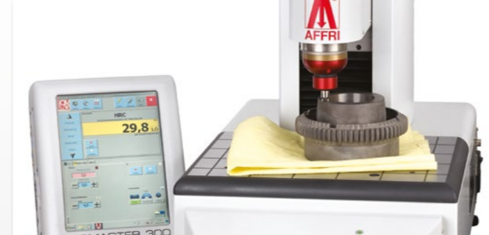
Podczas badania niestabilnych próbek lub części odchylających system AFFRI podąża za próbką i nie traci z nią kontaktu. Dokładne pomiary już w pierwszym badaniu eliminują potrzebę wielokrotnych powtarzanych testów.
