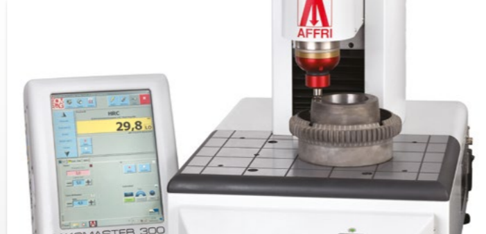
Podczas badania niestabilnych próbek lub części odchylających system AFFRI podąża za próbką i nie traci z nią kontaktu. Dokładne pomiary już w pierwszym badaniu eliminują potrzebę wielokrotnych powtarzanych testów.
