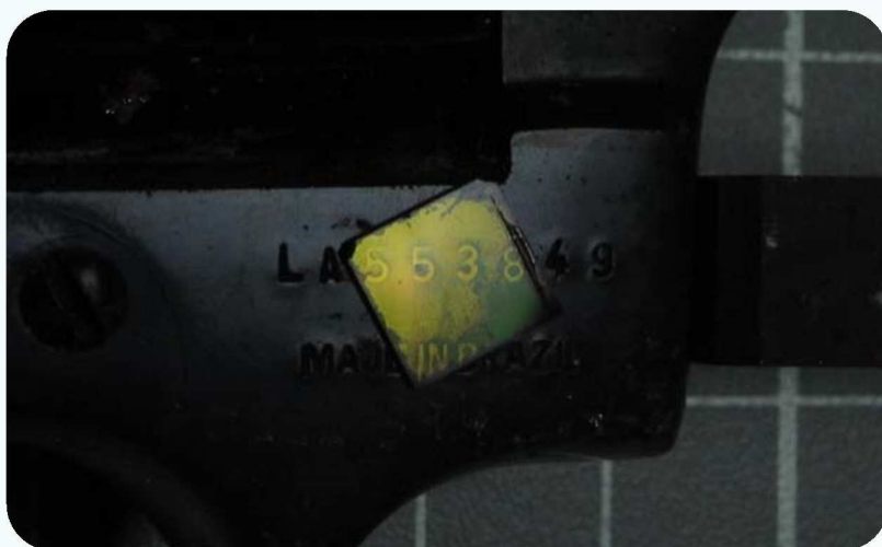
Metodologia za pomocą zestawu czujników MO ukazująca autentyczność numerów seryjnych.
