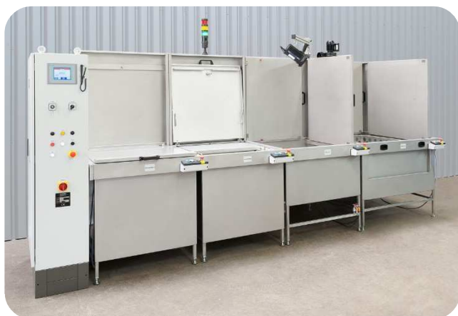
Manualny system czterostanowiskowy z szafą sterowniczą: stanowisko penetrantu – wanna zanurzeniowa, stanowisko zmywania i oceny oraz stanowisko nanoszenia wywoływacza z filtrowanym wyciągiem.
