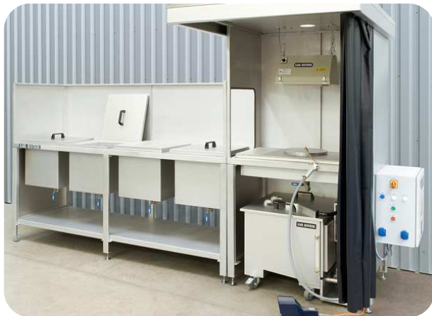
System manualny, z filtracją zużytego penetrantu i ciemnią.
