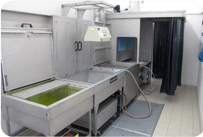
Manualny system stacjonarny z wanną zanurzeniową, stacją mycia, suszarką oraz stacją wywoływania/oceny.
