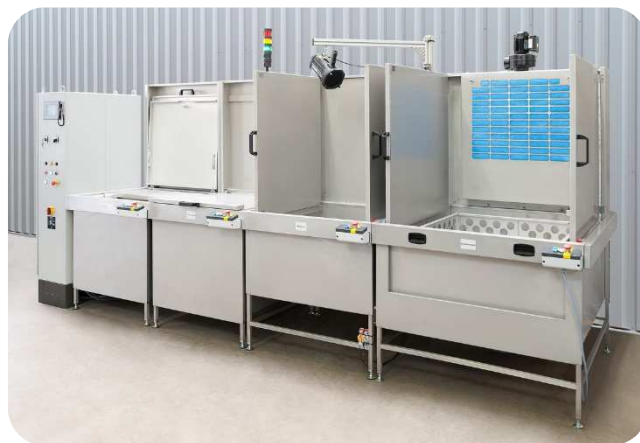
Manualny system czterostanowiskowy z szafą sterowniczą: stanowisko penetrantu – wanna zanurzeniowa, stanowisko zmywania i oceny oraz stanowisko nanoszenia wywoływacza z filtrowanym wyciągiem.
