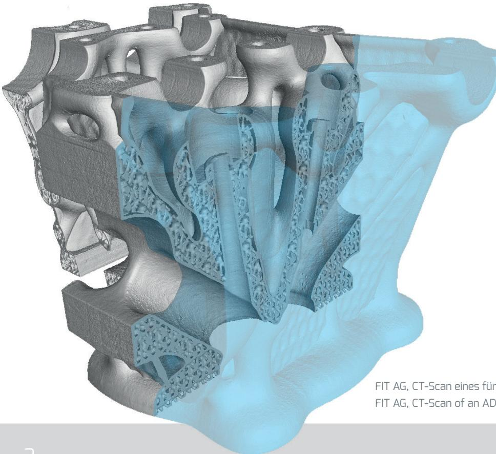
FIT AG, CT-Scan eines für die additive Serienfertigung optimierten Zylinderkopfes
